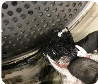
Beispiel aus dem Innenleben eines Aerosolabscheiders, welcher nur 1 Monat an einem Drehautomat (Mazak) im Einsatz war.
